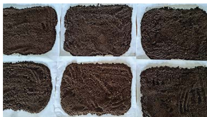
Assecatge a laboratori de mostres de sòl garbellat per a la seva anàlisi posterior.
